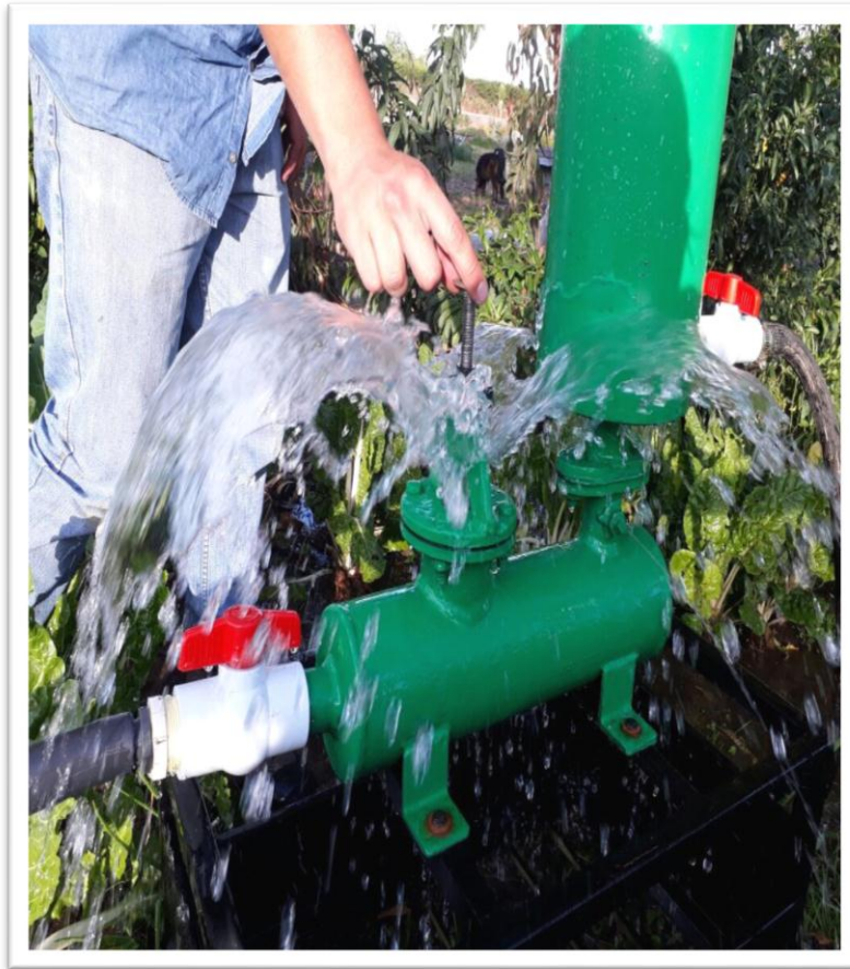
Figura 25: Calibración de válvula de impulso
