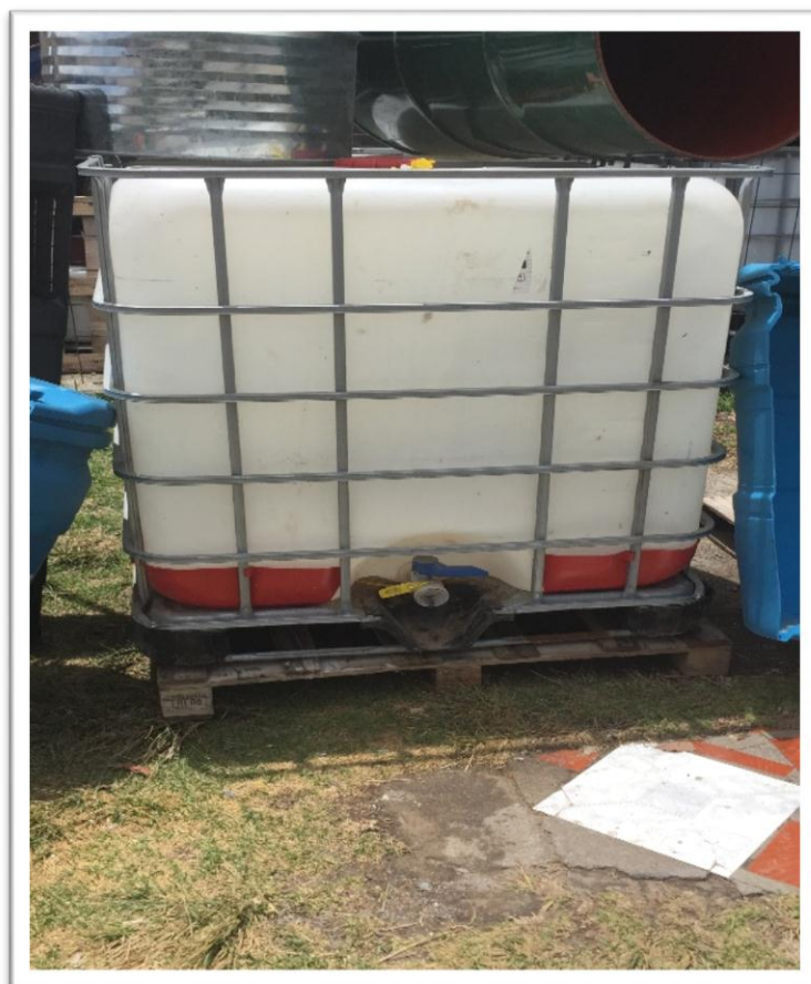
Figura 16: Tanque reservorio de 1000 litros
