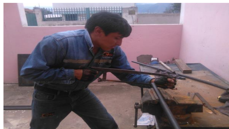
Corte de tubos y barrilas para la torre del Aerogenerador
