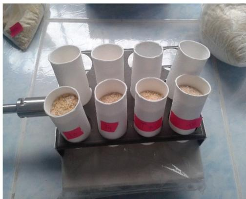
**FOTOGRAFÍA 8.** Pesaje de las muestras y colocación en los cartuchos de celulosa
