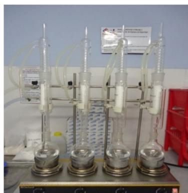
**FOTOGRAFÍA 9.** Ensamble del equipo soxhlet
