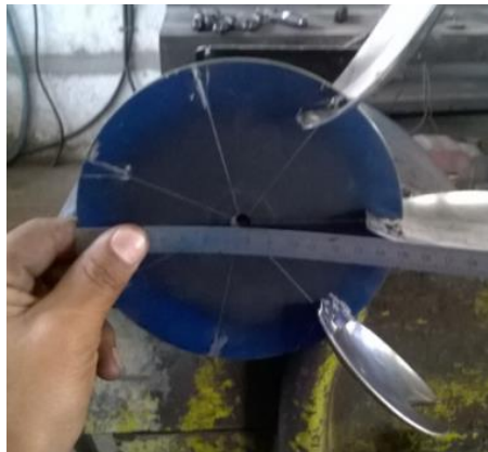
FIGURA 3. 20 Soldeo del álabe en el rodete
