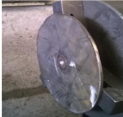
FIGURA 3. 16 Rodete de la turbina Pelton
