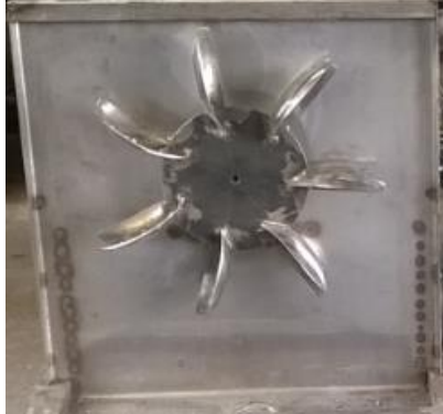
FIGURA 3. 21 Carcaza de la turbina Pelton
