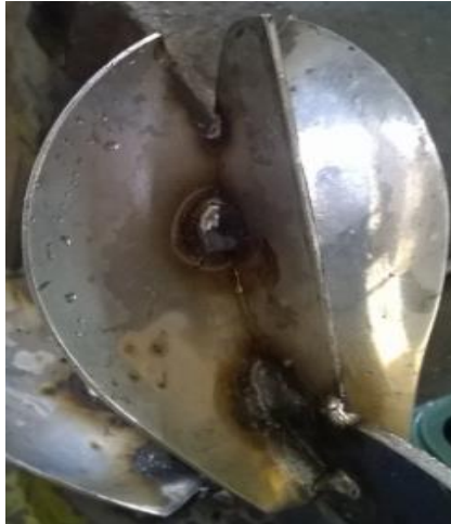
FIGURA 3. 19 Álabe o cuchara de la turbina Pelton
