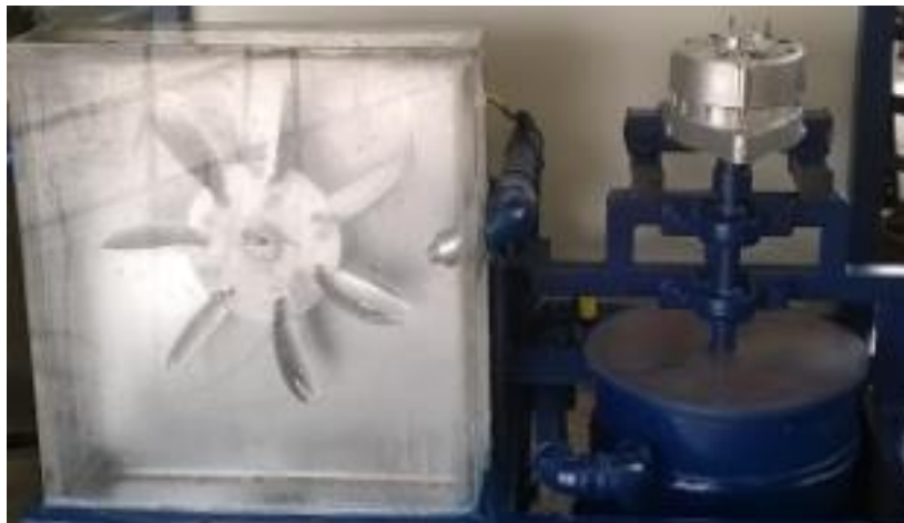
Figura 3.32 Implementación de las turbinas Pelton y Kaplan
