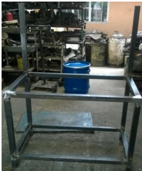
FIGURA 3. 28 Estructura o armazón del banco de pruebas
