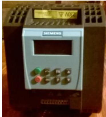
FIGURA 3.3 Variador de frecuencia
