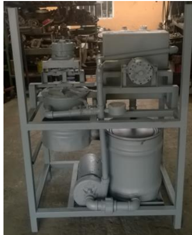
FIGURA 3. 33 Implementación de tubería de presión, manómetro y llaves de paso
