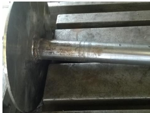
FIGURA 3. 17 Eje de la turbina Pelton
