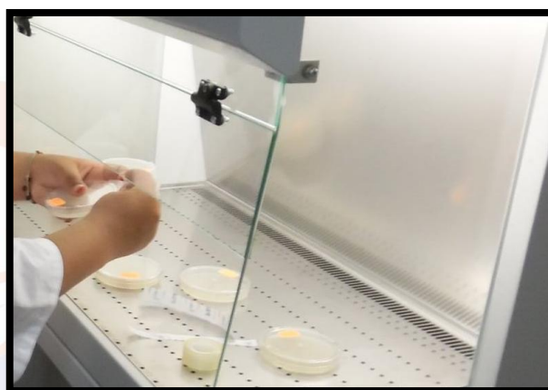
Fig. 12 utilizando la cámara de flujo laminar se realiza la siembra.
