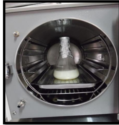
Fig. 10 paso4. Colocado en el autoclave 35 minutos.
