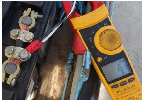
**Figura 3. 21** Medición de Corriente Consumida por el Sistema de Iluminación Principal de 12V Incluido el PLC y Ventilador.
