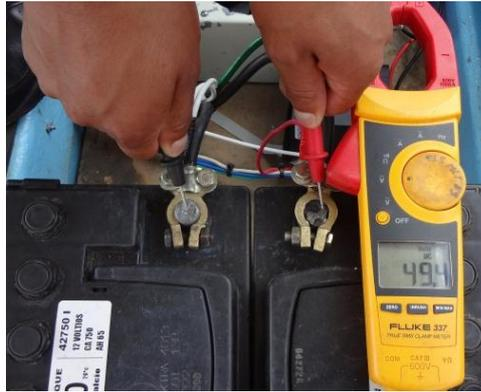
**Figura 3. 16** Medición de voltaje en los bornes del banco de baterías a su plena carga.
