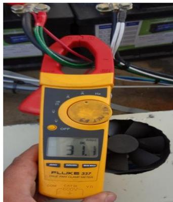
**Figura 3. 19** Medición del Consumo de Corriente Nominal Cuando el Motor se Estabiliza.
