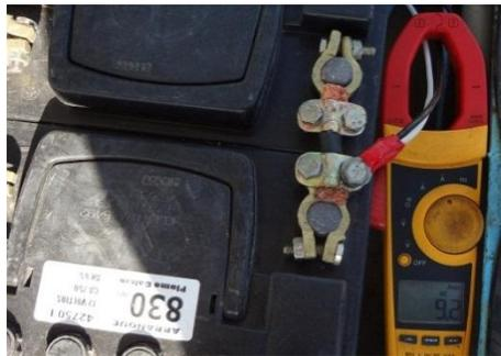
**Figura 3. 22** Medición de Corriente Consumida por el PLC, Ventilación del Cargador, Iluminación de Faros, Direccionales de 12V.
