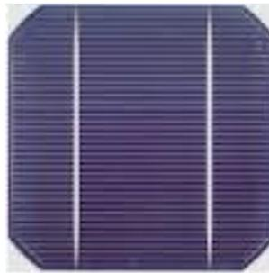
**Figura 1. 5** Celda Solar Monocristalina.
