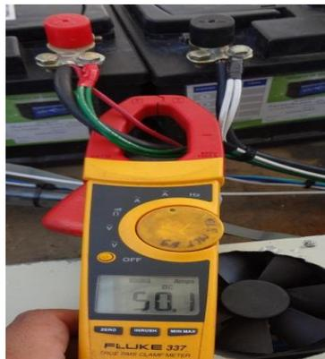
**Figura 3. 18** Medición de Corriente Máxima de Arranque Consumida por el Motor de Corriente Continua (C.C.) de dos HP.
