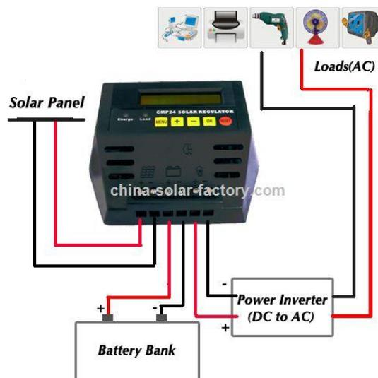
**Figura 1. 18** Controlador de Carga Solar.
