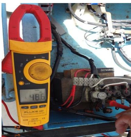
**Figura 3. 15** Medición de Voltaje Rectificado para el Circuito del Cargador del Banco de Baterías.
