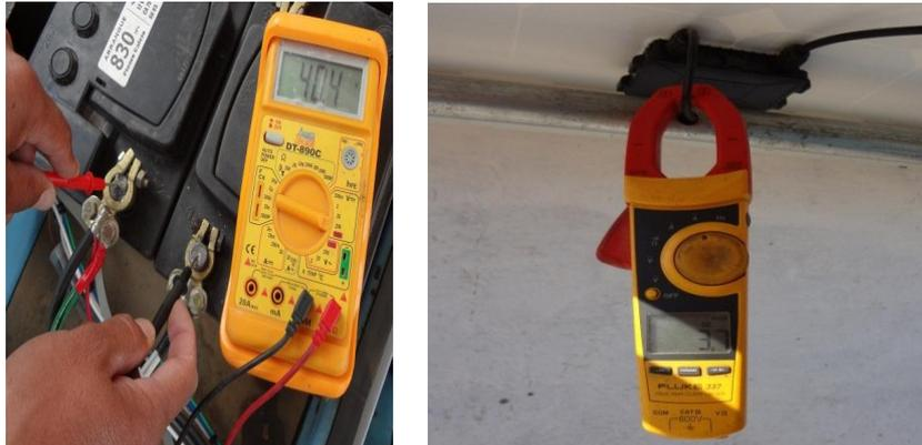
**Figura 3. 13** Medición de Corriente Entregada por el Banco de Paneles Fotovoltaicos hacia el Banco de Baterías.
