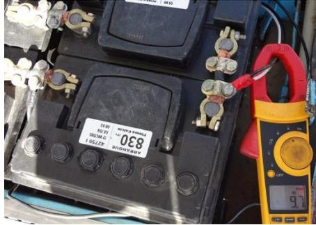
**Figura 3. 23** Medición de Corriente Consumida por el PLC, Ventilación del Cargador, Iluminación de Faros, Direccionales y Señales Acústicas de 12V.
