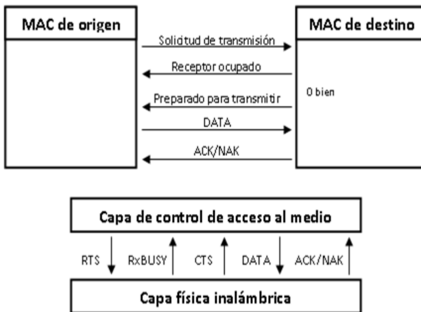
Figura 1.5 Esquema general del mecanismo CSMA/CA.
