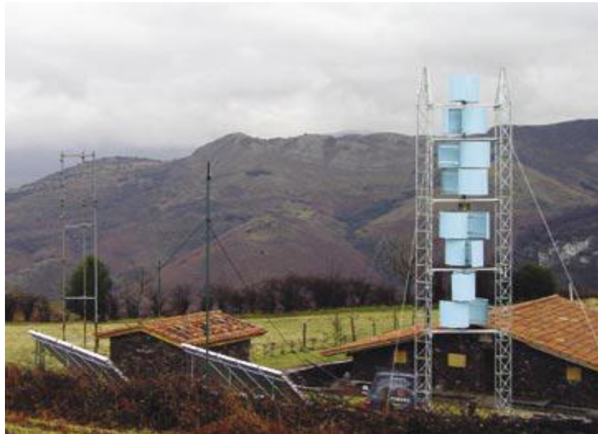
Figura 9 Aerogenerador con rotor Savonius.
