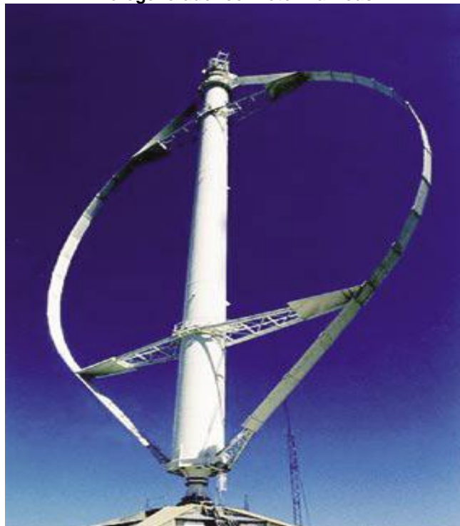
Figura 10 Aerogenerador con rotor Darrieus.
