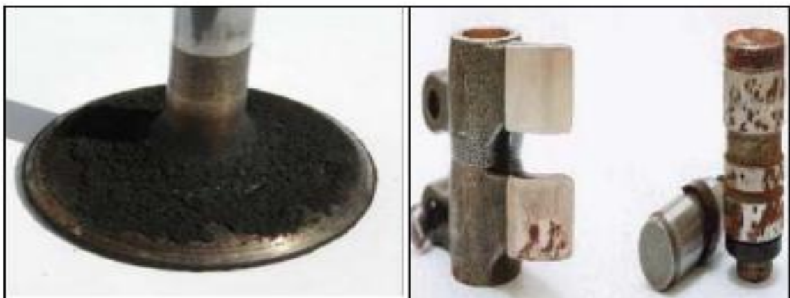
Figura 1.3: Efecto del azufre en la válvula de escape y su ataque químico sobre la superficie.
