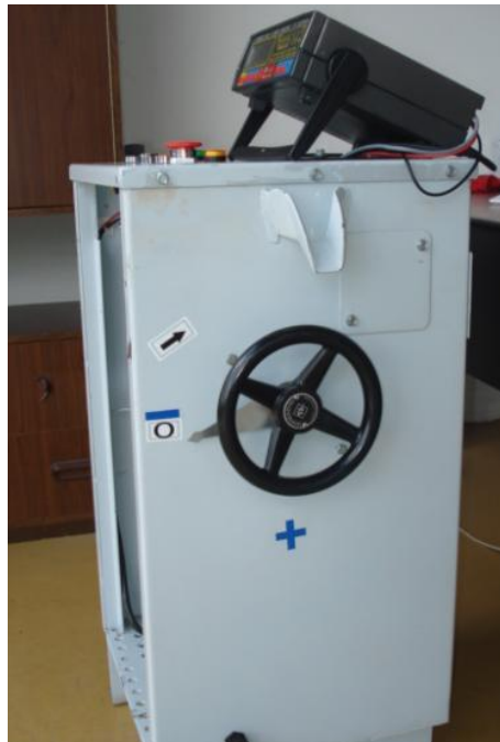
Figura 3.8.- Vista del equipo para pruebas de transformadores
