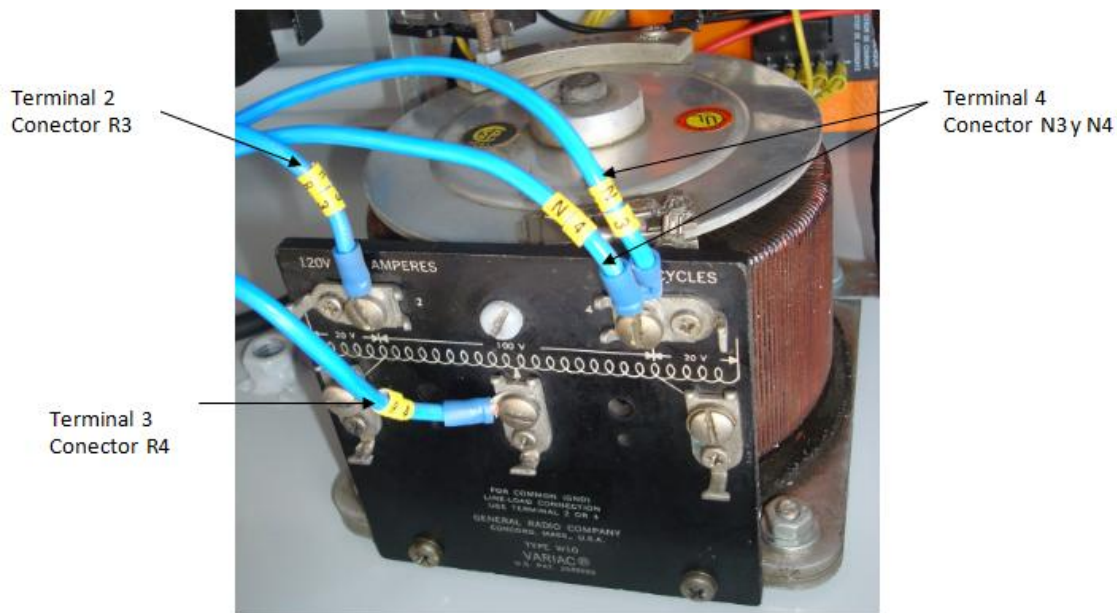
Figura 3.7.- Variac utilizado en el equipo de pruebas de transformadores
