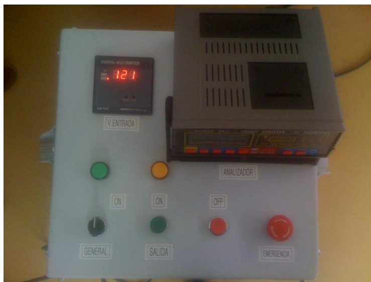
Figura 3.9.- Panel frontal de control y medida del equipo de pruebas de pérdidas en vacío y cortocircuito de transformadores
