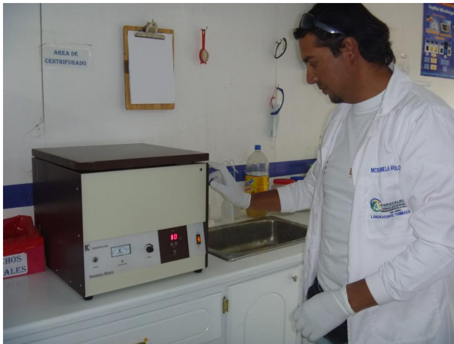
Fotografía No. 23: Se observa la centrifuga en funcionamiento
