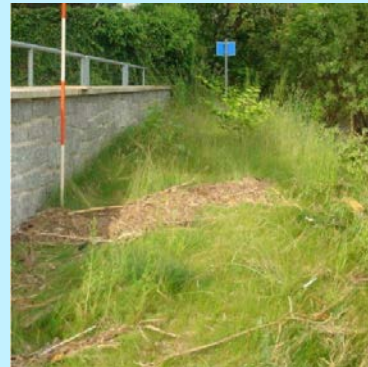
Abbildung 19, links: Geschwemmsellinie markiert durch plattgedrücktes Gras (IÖR, 2018), (rechts) Geschwemmsellinie markiert durch Treibgut (LfULG, 2015)
