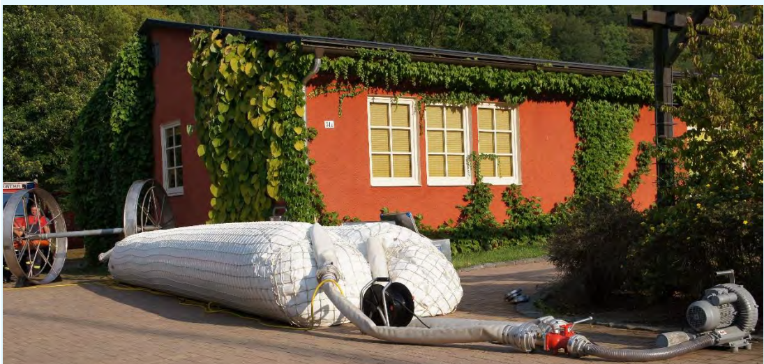
Abbildung 16: Mobiles Deichsystem der Stadt Glashütte
