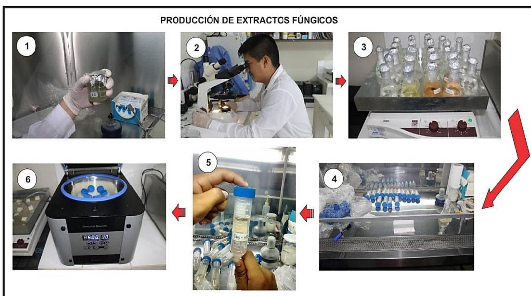
**Figura 16:** Proceso de producción de extractos fúngicos de microendófitos de sachá inchi: 1) fuente de inóculo conteniendo suspensión líquida de conidias de microendófitos. 2) cuantificación de conidias. 3) matraces en agitación, produciendo metabolitos secundarios. 4) filtración de extractos fúngicos en tubos falcón de 50 ml. 5) aislamiento presentando impurezas. 6) centrifugado a 5 000 rpm. Fotos: Padilla, A. 2015.
