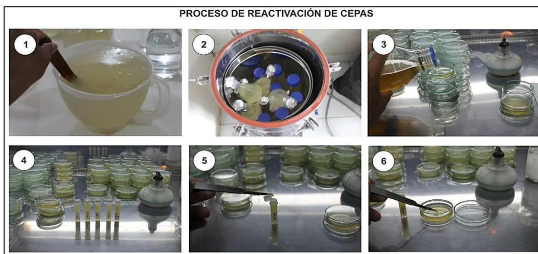
**Figura 4:** Proceso de reactivación de cepas. 1) preparación de medio de cultivo PSA. 2) esterilización de materiales. 3) plaqueo de medio PSA + O en placas de de Petri de 15 x 60 mm. 4) viales conservados conteniendo micelio de los aislamientos. 5) extracción de agar conteniendo micelio de los aislamientos. 6) siembra de micelio en placas conteniendo medio PSA + oxitetraciclina. Fotos: Padilla. A. 2015.
