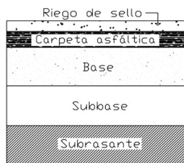
**Figura 6:** Pavimento Flexible (Fuente: Manual para el Diseño de Carreteras No Pavimentadas de Bajo Volumen de Tránsito.)
