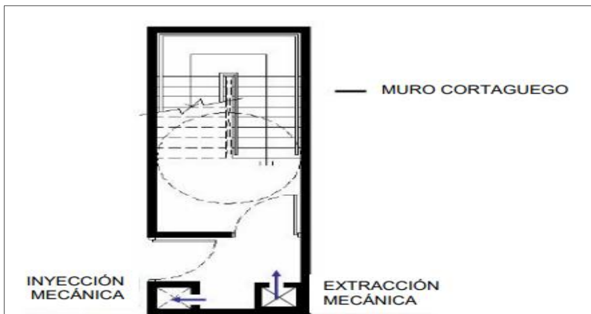
Figura 61. Escaleras de evacuación con vestíbulo previo, que ventila a través de un sistema de extracción mecánica. Fuente: RNE.
