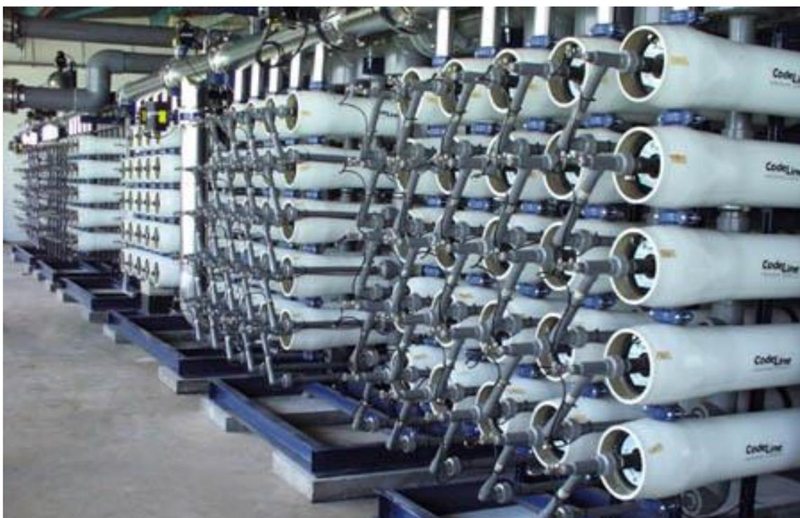
La evaporación es un método convencional utilizado para la concentración y recuperación en la industria de alimentos. Este es un proceso intensivo de energía ya que los materiales se tienen que calentar para evaporar el exceso de líquido. Como un método alternativo, la filtración por membrana se puede usar cuando se utiliza una membrana permeable y se aplica una fuerza conductora para separar los materiales.
