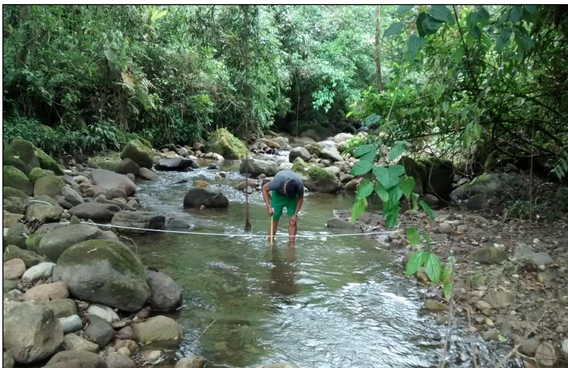
Fotografía 7. Medición del tirante hidráulico de la quebrada Urcuyacu - Sección 2
