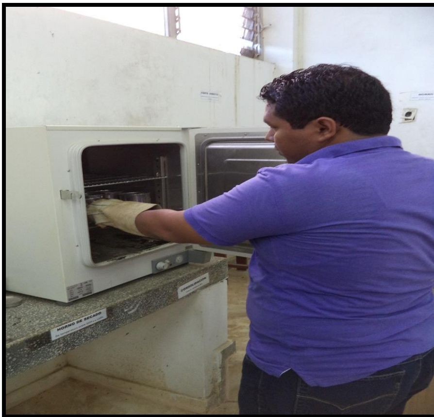
Foto 19: Colocación de muestras en el horno
