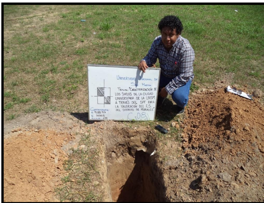
Foto 12: Excavación de la calicata N° 08
