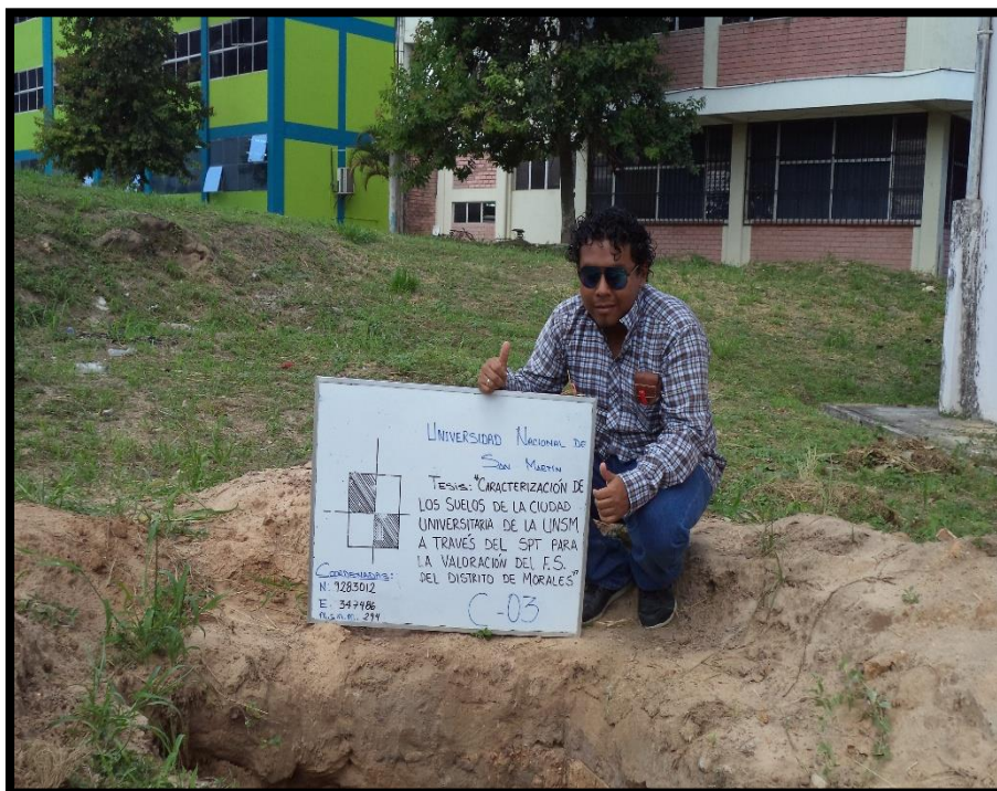
Foto 7: Excavación de la calicata N° 03
