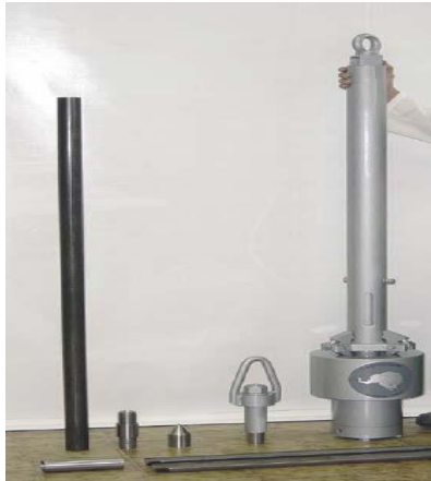
Figura 6: Dispositivo automático de caída del martillo
