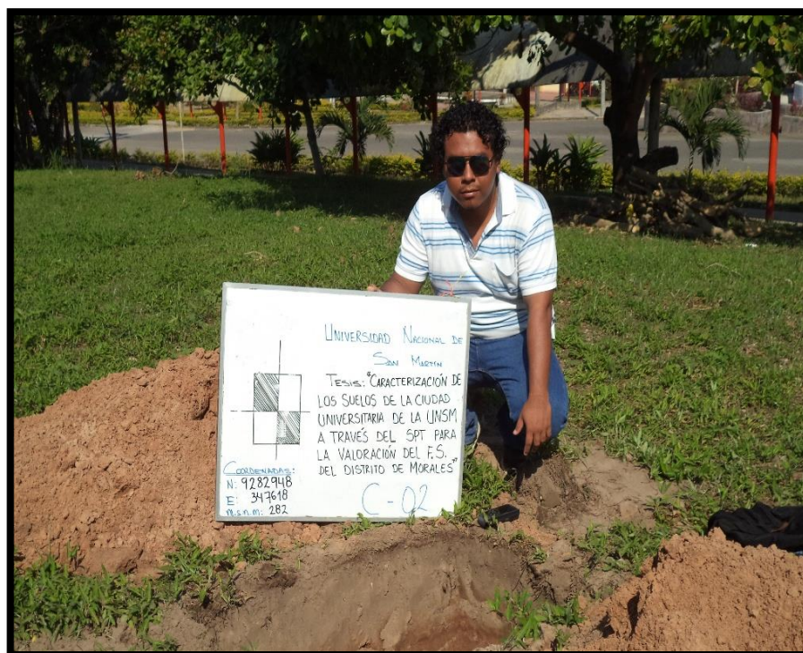
Foto 6: Excavación de la calicata N° 02
