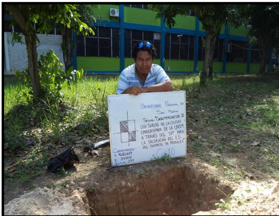
Foto 14: Excavación de la calicata N° 10
