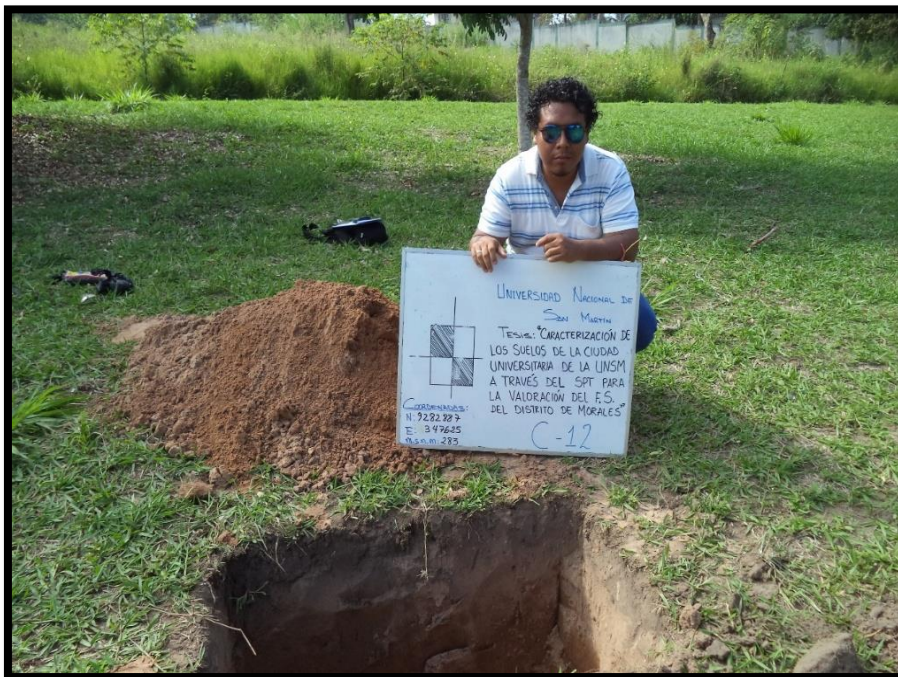
Foto 16: Excavación de la calicata N° 12
