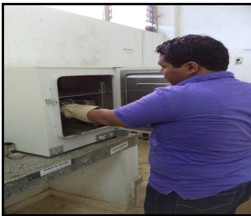
Foto 3: Colocación de muestras en el horno
