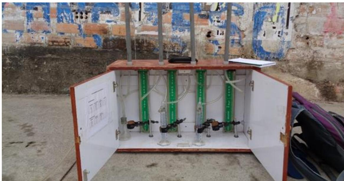
*Fotografía 2:* Tren de muestreo para hidrocarburos
