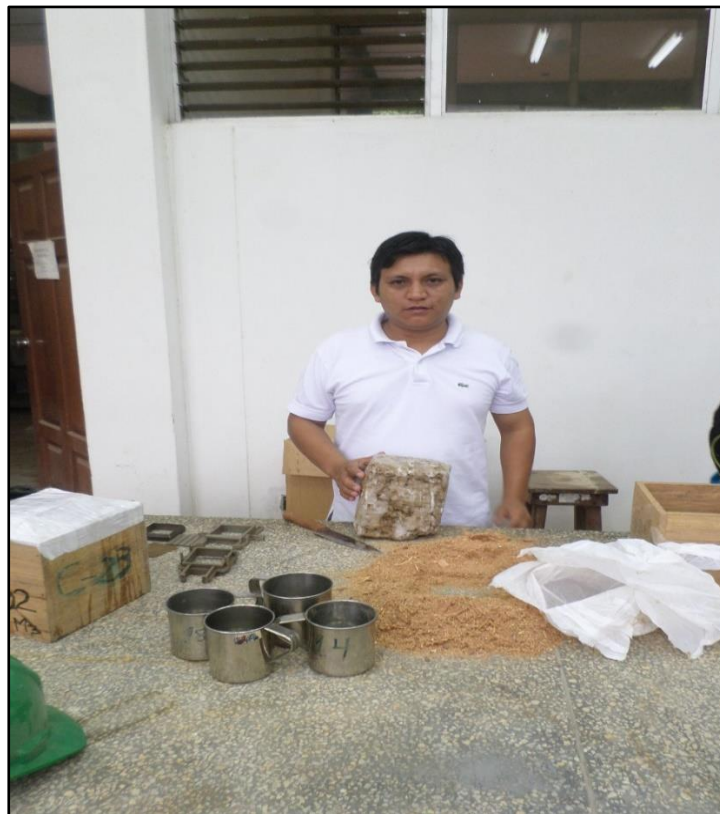
Foto N° 25: En la foto se observa la muestra de suelo en el laboratorio de mecánica de suelos de la UNSM para el ensayo de corte directo.
