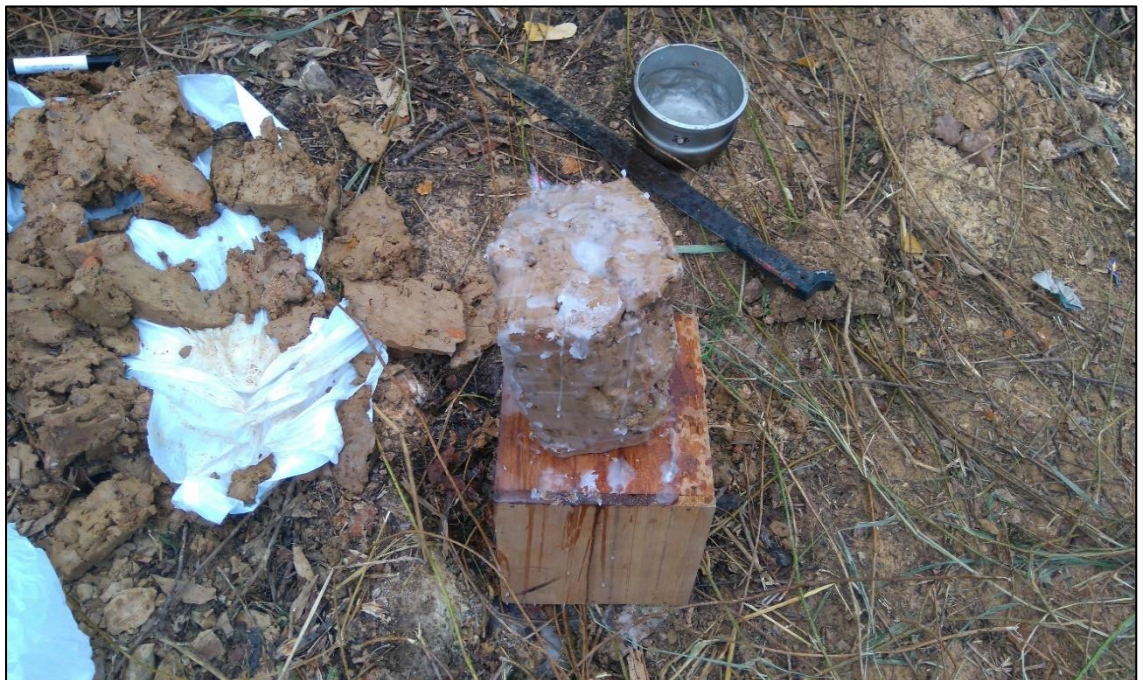
Foto N° 23: En la foto se observa el recubrimiento con cera de la muestra de suelo de la calicata C-2 para conservar sus propiedades físicas y químicas en la progresiva km 08+200.
