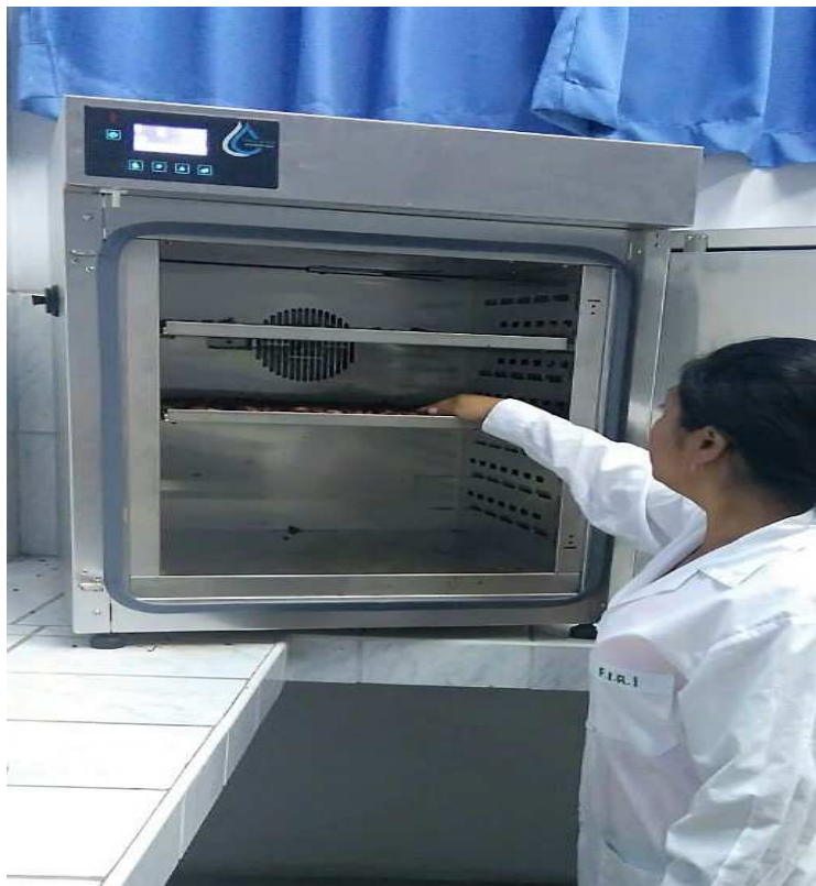
Anexo 11: Secado en estufa. Remoción de la masa para uniformizar el secado.
