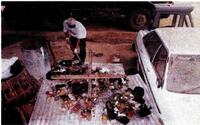
FOTO N° 11 : Método de Cuarteo - Residuos Domésticos.
