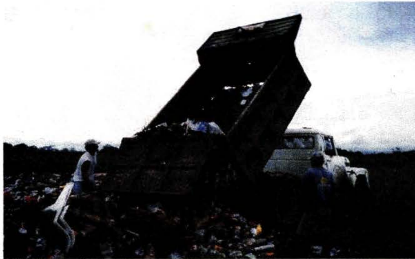
FOTO N° 38: Descarga de los residuos sólidos con apoyo de los obreros recolectores y vista de las condiciones deterioradas de la tolva del vehículo recolector.
