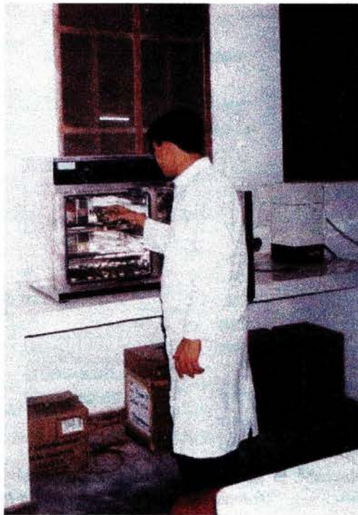
FOTO N° 18: Colocación de muestra de residuos sólidos en la estufa a 105 °C (determinación de contenido de humedad).
