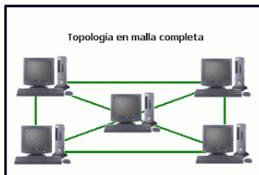
Figura 05: Topología Malla Completa
