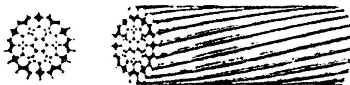
**Figura 05:** Torón estructural y su sección transversal.
