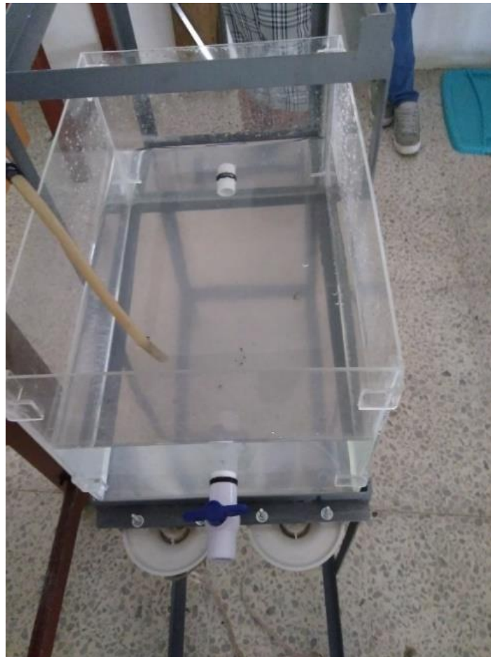
Ilustración 30 Inyección de ozono en tanque de agua
