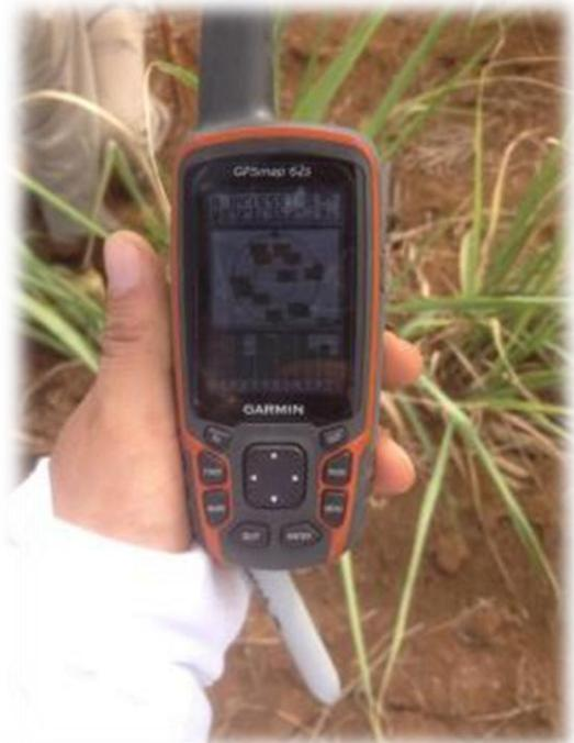
**Ilustración 8. GPS Garmin 62s verificación del margen del margen de error y numero de satélites con señal**
