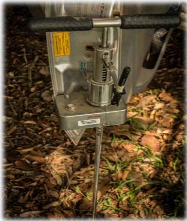
**Ilustración 11. Penetrografo con el cual realizamos la toma de resistencia a la penetración en campo.**
