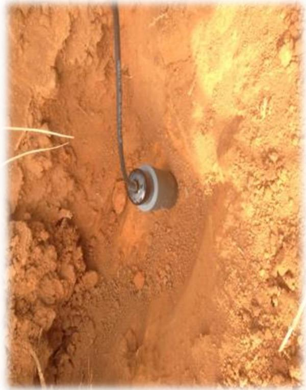
**Ilustración 6. Sonda SM150 conectada al sensor HH2**
