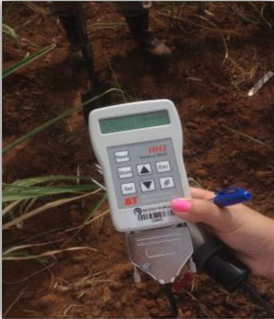
**Ilustración 5. Sensor HH2 toma de humedad de campo**
