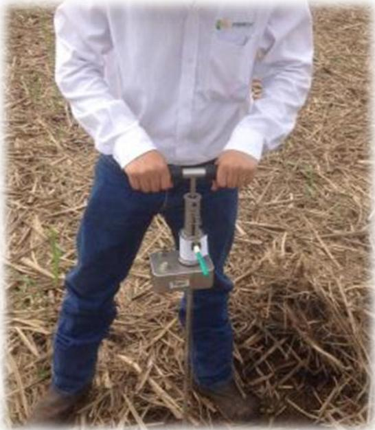
**Ilustración 10. Toma de datos de penetrabilidad con el Penetrografo**
