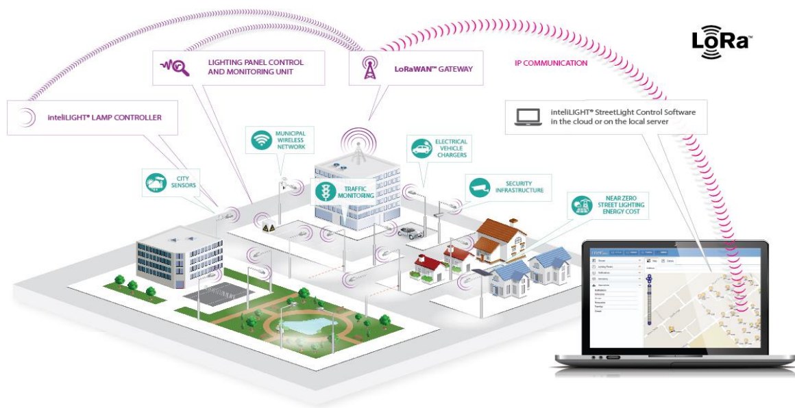
Ilustración 16 Sistema de arquitectura LoRa con IntelliLIGHT. Las soluciones de alumbrado público basadas en LoRaWAN se hacen realidad con los nuevos controladores IntelliLIGHT. Tomado de IntelliLIGHT®. [63]
