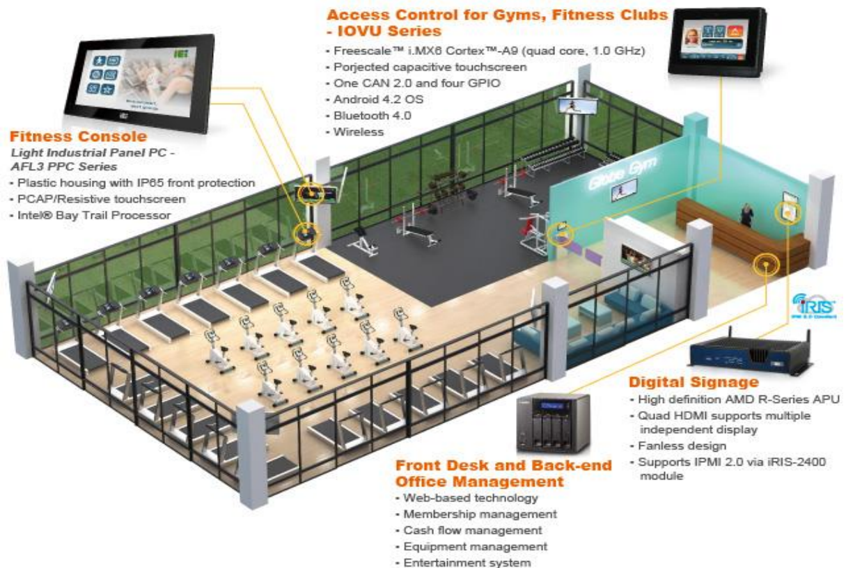
Ilustración 14 Centro de acondicionamiento físico personalizado usando servicios IoT y el modelo de comunicación back-end Tomado de Fitness Solution. [50]
