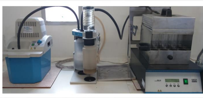
Fotografía 5. Equipo automático proteína y Scrubber (Tomada por autores, 2017)
