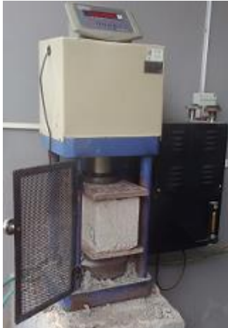
Fig. 2. se observa 1 bloques de hormigón de denominación (400x200x150) mm preparado para el ensayo de resistencia a la compresión.
