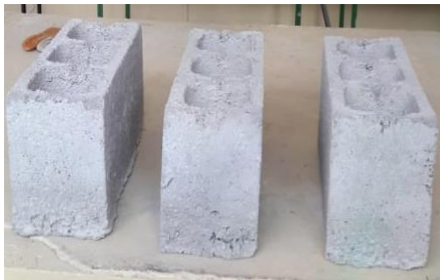
Fig. 1. se observan de bloques de hormigón de denominación (400x200x150) mm preparados para el ensayo de dimensiones.
