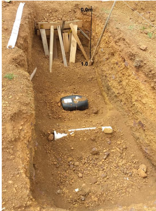
Figura 14 – Aspecto dos alvos dispostos nas trincheiras 07 A, em diferentes profundidades na área do SCGRA-ENG da UEG/CCET.
