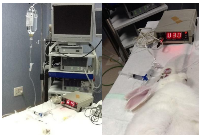
Fig 11. Ejemplo de modelo animal. Medición del cambio de ECC ante cambios bruscos de PIO mediante canulación directa de CA. (Extraído de la comunicación en panel titulada “Effect of acute increases of the intraocular pressure on the corneal pachymetry in eyes treated with timolol maleate. An animal study”.” presentado en el 11º EGS, Niza Junio 2014).
