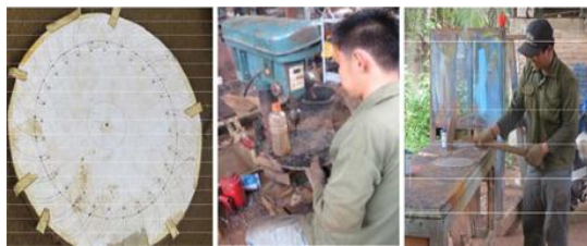
Gambar 3. penandaan dan meratakan pembuatan disc runner
