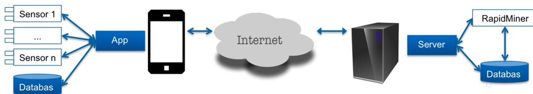
**Abb. 2.21.:** Client-Server-Modell zur Entwicklung eines Prototyps. Die Klassifikation der Sensordaten erfolgt auf einem Server mit Hilfe von RapidMiner.
