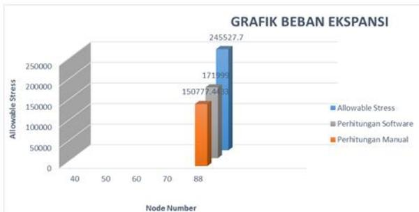
Gambar 4.9. Grafik perbandingan nilai Ekspansi load manual dan Software
