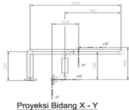
Gambar 4.2. Posisi *centroid* sistem perpipaan pada bidang X-Y
