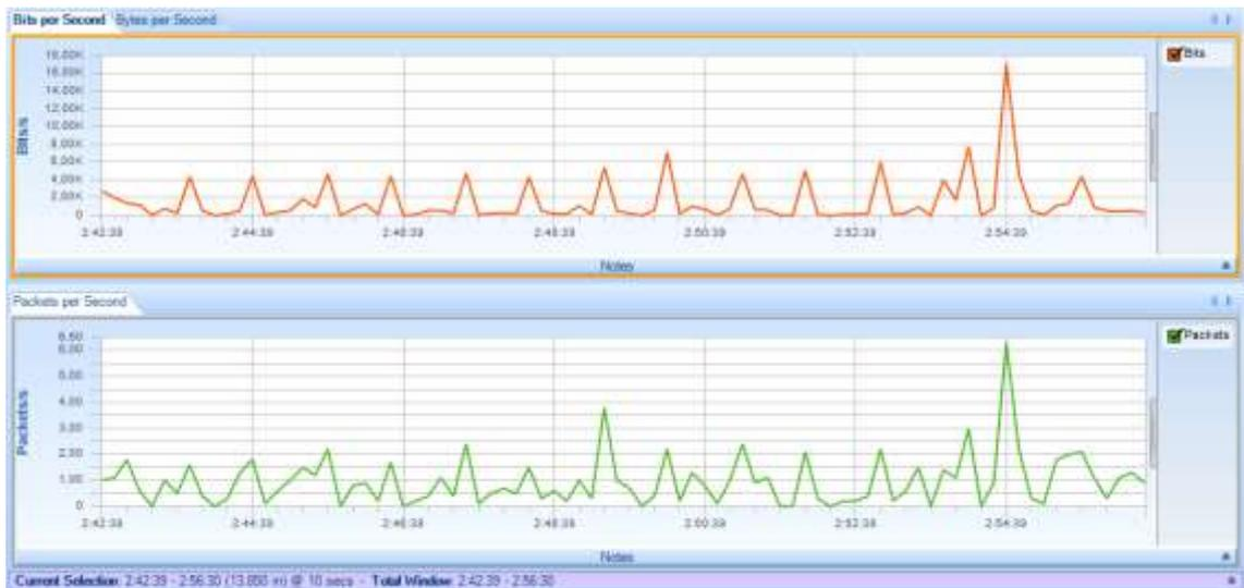
**Figura 9-3:** Bits por segundo y paquetes transmitidos con Wi-Fi del controlador de temperatura
