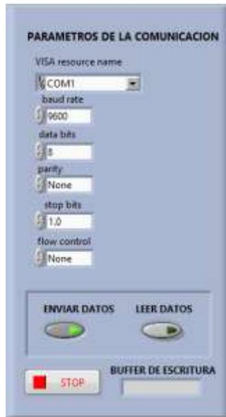
**Figura 50-2:** Configuración de la comunicación ZigBee
