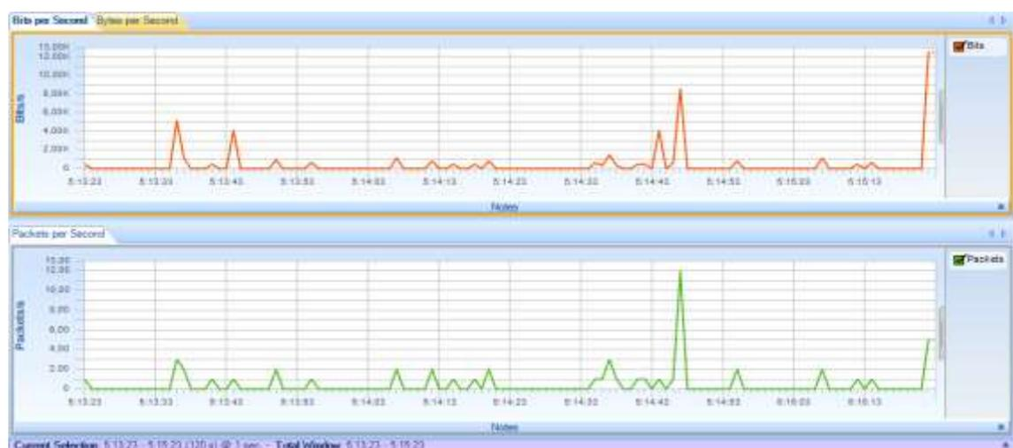
**Figura 3-3:** Bits por segundo y paquetes transmitidos con Li-Fi del controlador de velocidad
