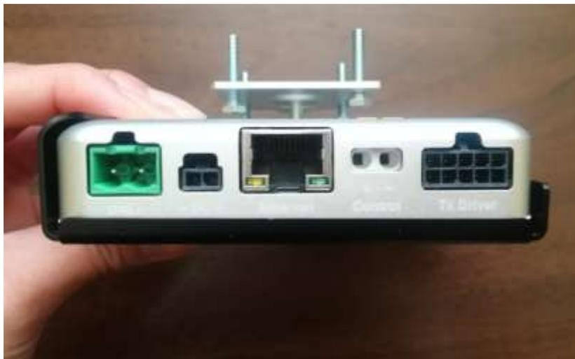
**Figura 3-2:** Pines de conexión del Access point
