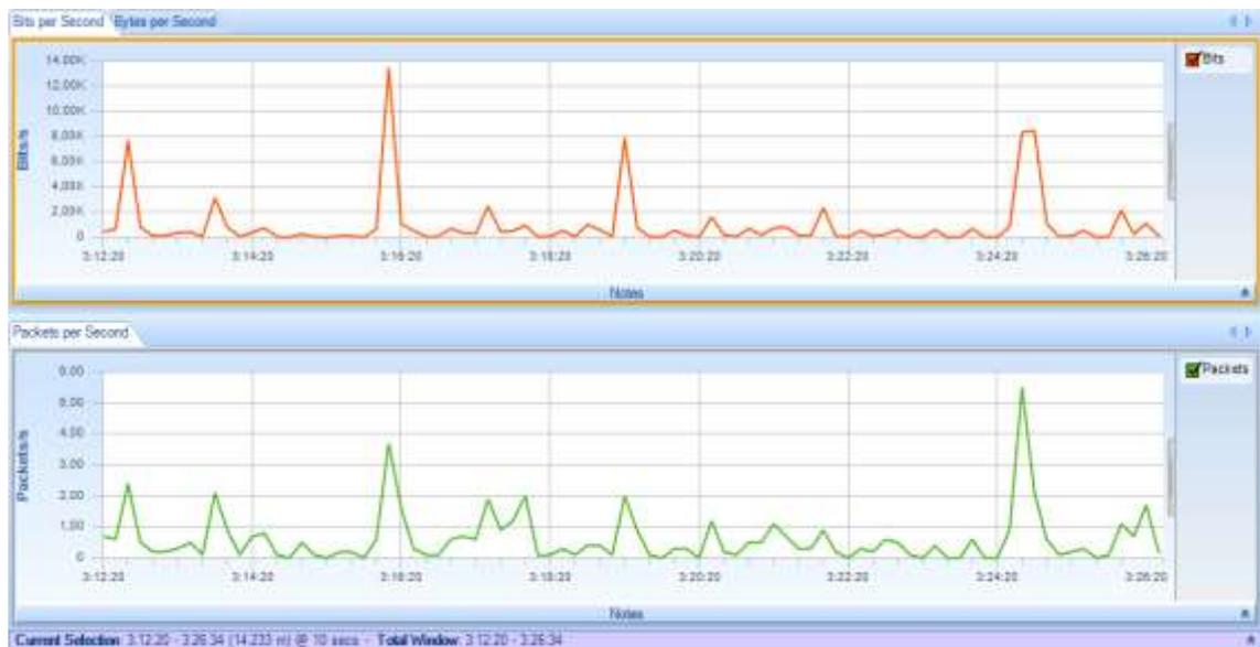
**Figura 5-3:** Bits por segundo y paquetes transmitidos con Li-Fi del controlador de temperatura
