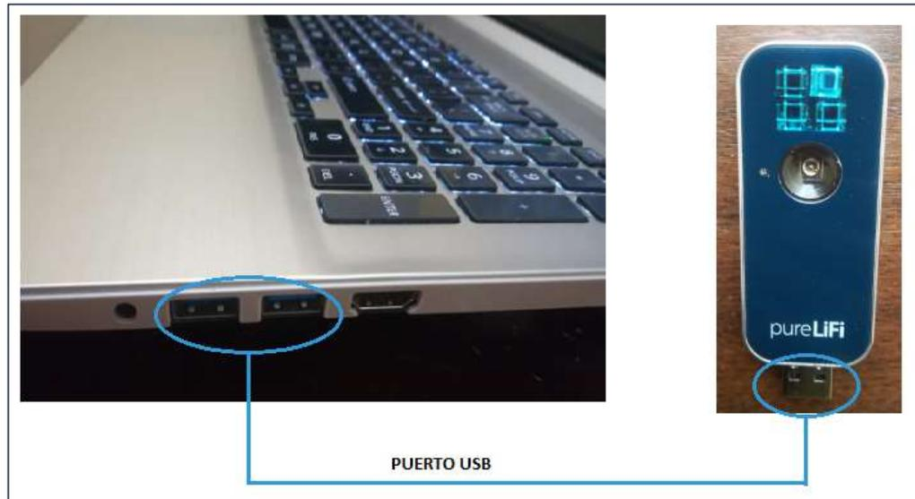
**Figura 18-2:** Esquema de conexión del Tx station con la computadora.
