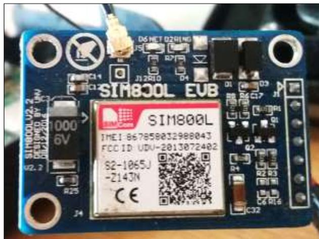
**Figura 9-2:** Módulo GPRS SIM 800L
