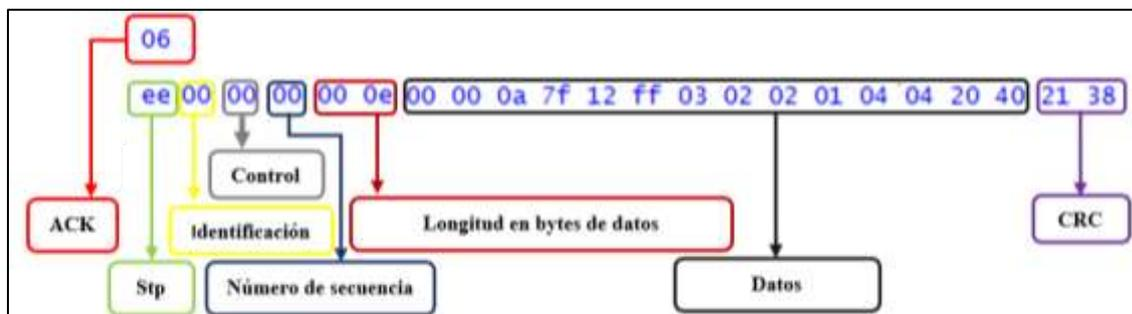
**Figura 5-2:** Estructura de paquetes ANSI C12.18
