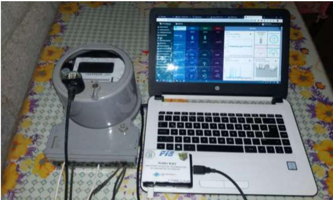
**Figura 2-3:** Prototipo Telenergy funcionando con nodo Wi-Fi
