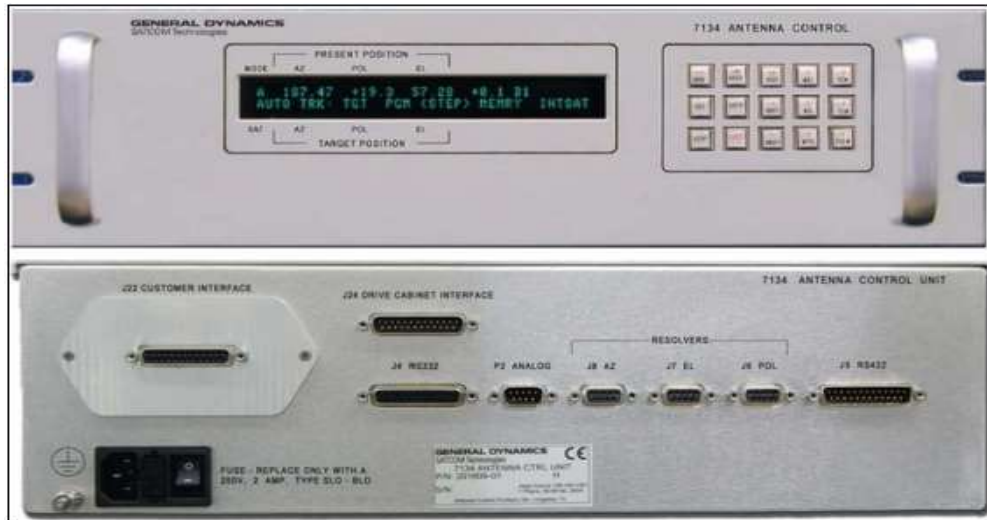
Figura 6-1: Panel de sistema de control de antena modelo 7134 Fuente: (Dynamics, 2010).
