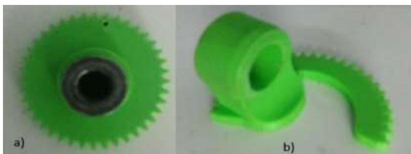
Figura 17-2: Engranajes a) para azimut, b) para elevación Realizado por: Byron U. y Cristian V.; 2019.
