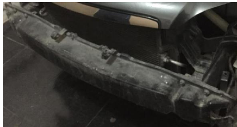
Figura 18-2: Atenuador de impacto de PP-GF45
