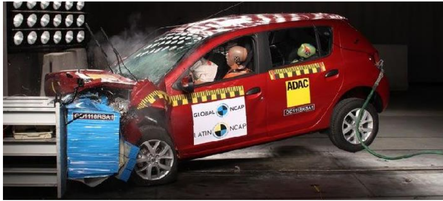
Figura 20-2: Renault Sandero durante las pruebas de choque en Latin NCAP
