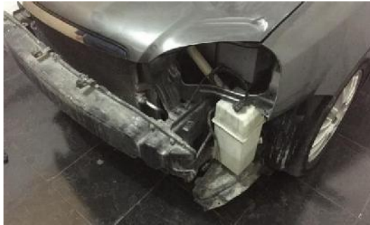
Figura 3-3: Atenuador de impacto del Chevrolet Optra 1.8
