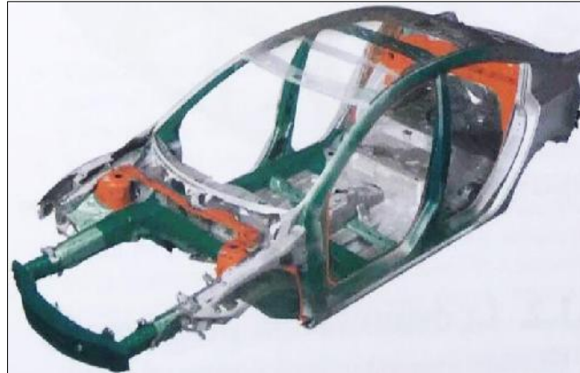
Figura 2-2: Elemento "anticolisión" en el soporte del paragolpes delantero
