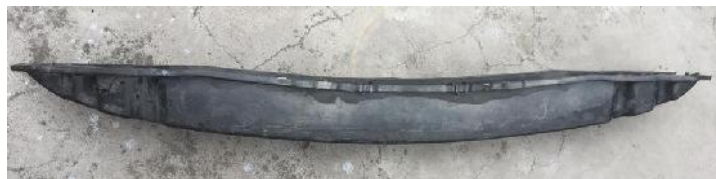
Figura 4-3: Atenuador de impacto
