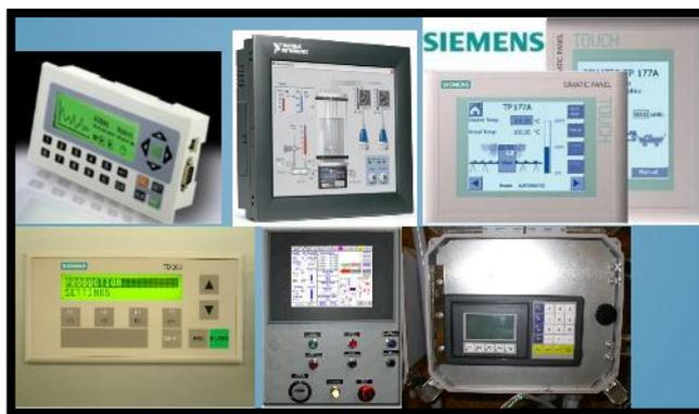
**Figura 2-1.** Ejemplo de HMI
