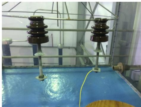
Figure 4: Isoladores Classe 15kV utilizados no experimento, conectado ao arco com tensão aplicada de 7,95kV fase terra, que representa os cabos elétricos da rede de distribuição. O cabo conectado no pino de sustentação do isolador está aterrado
