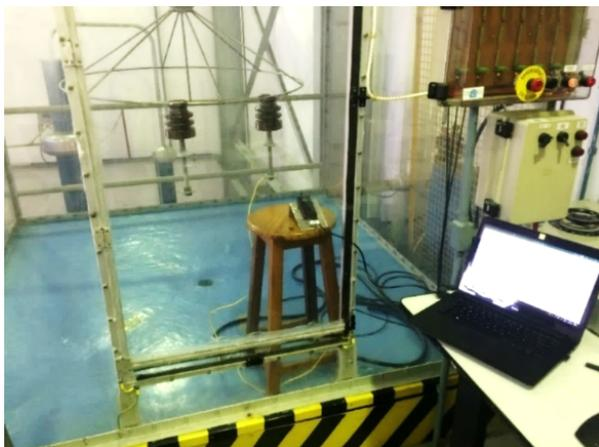
Figure 2: À esquerda isolador em bom estado de conservação, à direita isolador perfurado, no centro microfone de ultrassom conectado ao computador para análise de dados. Os isoladores e o microfone estão dentro de uma câmara fechada com o intuito de diminuir ao máximo as interferências externas.
