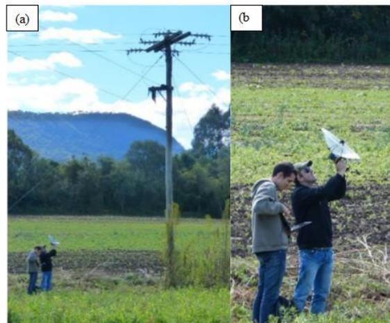
**Figure 1: Detalhamento da utilização de microfone de ultrassom para verificações da qualidade de isoladores da rede elétrica de distribuição, em (a) é apresentado o método de medição e em (b) é apresentado o detalhamento da microfone de ultrassom de maneira ilustrativa.**
