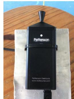
Figure 8: Microfone ultrassônico utilizado na aquisição de dados, fixado em suporte com o intuito de manter a inclinação fixa para todos os testes.
