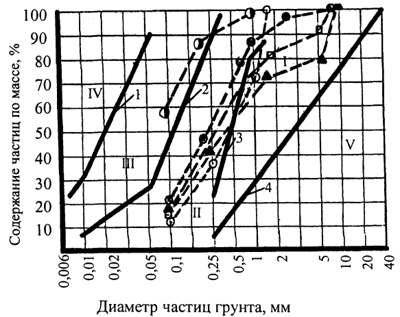
Рис. 4. Группы грунтов, используемых для намыва дамб: — СНиП 2.06.05–84: 1 – суглинки и глины; 2 – супеси; 3 – песок; 4 – песчано-гравийные грунты; - - - - - исследуемые грунты: ▲ – оптимального зернового состава 1; ○ – то же 2; ⊙ – берег водохранилища; ⊙ – ложа водохранилища; □ – со средними показателями зернового состава
