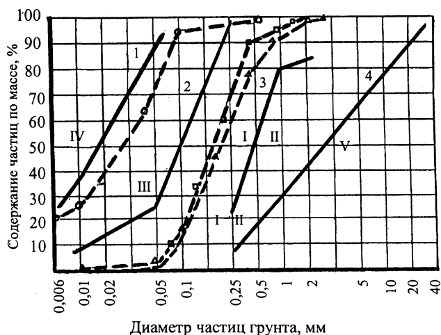
Рис. 1. Гранулометрический состав грунтов, СНиП 2.06.05–84: 1 – суглинки и глины; 2 – супеси; 3 – песок; 4 – песчано-гравийные грунты; - - - - грунты ложа Солигорского водохранилища: суглинок, скв. 62; песок мелкий, скв. 22; песок средний, скв. 63
