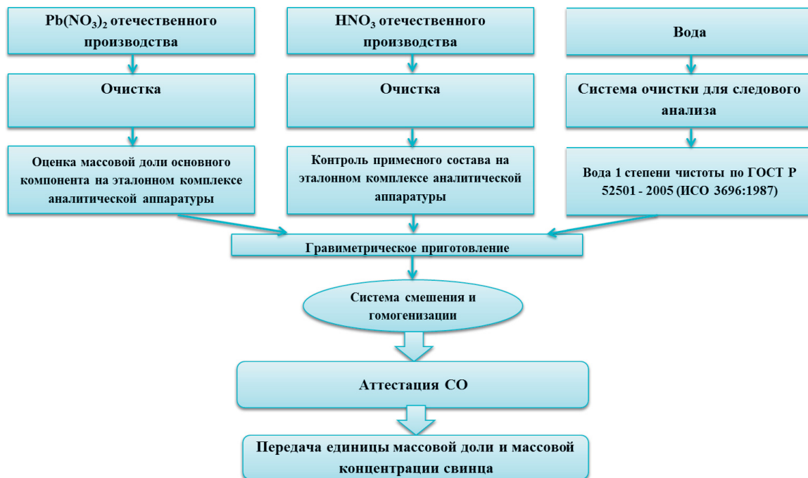
Рис. 1. Блок-схема приготовления стандартного образца массовой доли свинца из материалов отечественного производства Fig. 1. Block diagram describing the preparation of a CRM of the lead mass fraction
