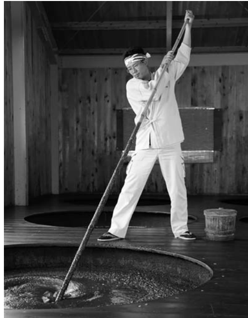
写真1 杉桶の中のもろみの攪入れ 出所：湯浅醤油ホームページ （写真中の人物は5代目の新古社長本人）
