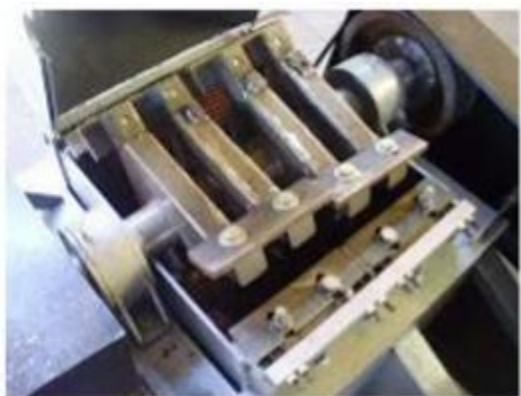
Figura 19. Interior de molino para plástico. Fuente: (López, 2016, pág. 67)
