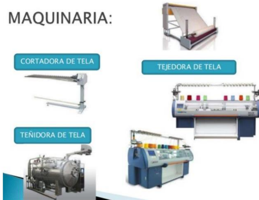
Figura 28. Maquinaria necesaria para el proceso de transformación de PET a tela. Fuente: (Guevara Palacios , Castro Castro , Guevara Collantes, Crovetto Casanova, & Escudero Gutierrez, 2017, pág. 87)
