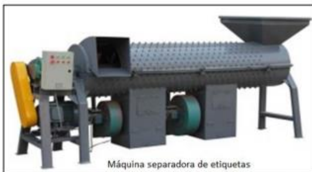
Figura 18. Máquina para retirar etiqueta y tapas de las botellas PET. Fuente: (López, 2016, pág. 65)
