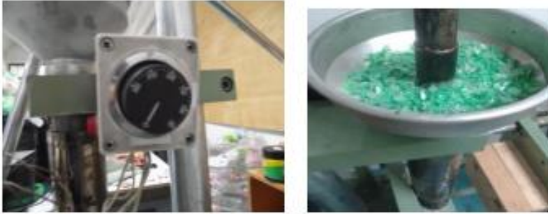
Figura 23. Máquina para fundir las escamas del PET. Fuente: (Obtención de fibras de poliéster a partir de botellas PET, pág. 13)
