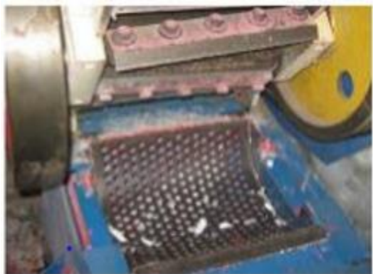
Figura 20. Criba del molino. Fuente: (López, 2016, pág. 67)
