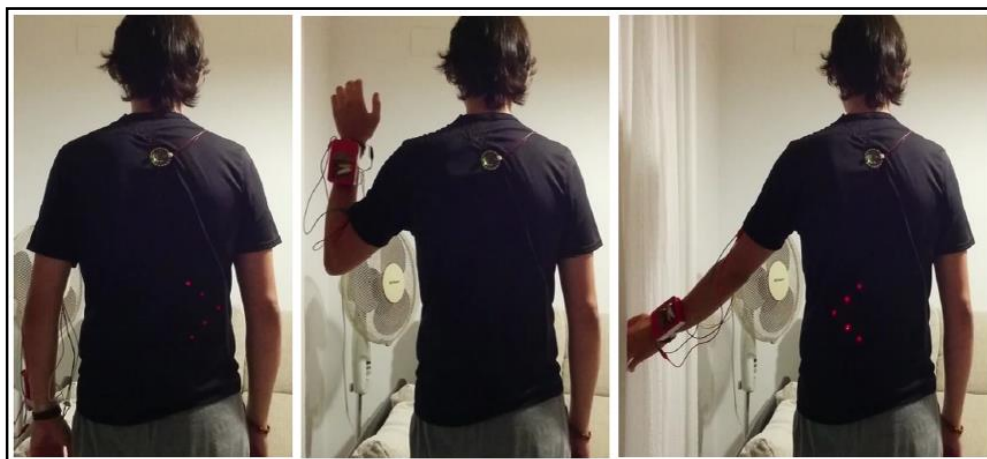
Figura 3. Sistema electrónico textil para señalización.
