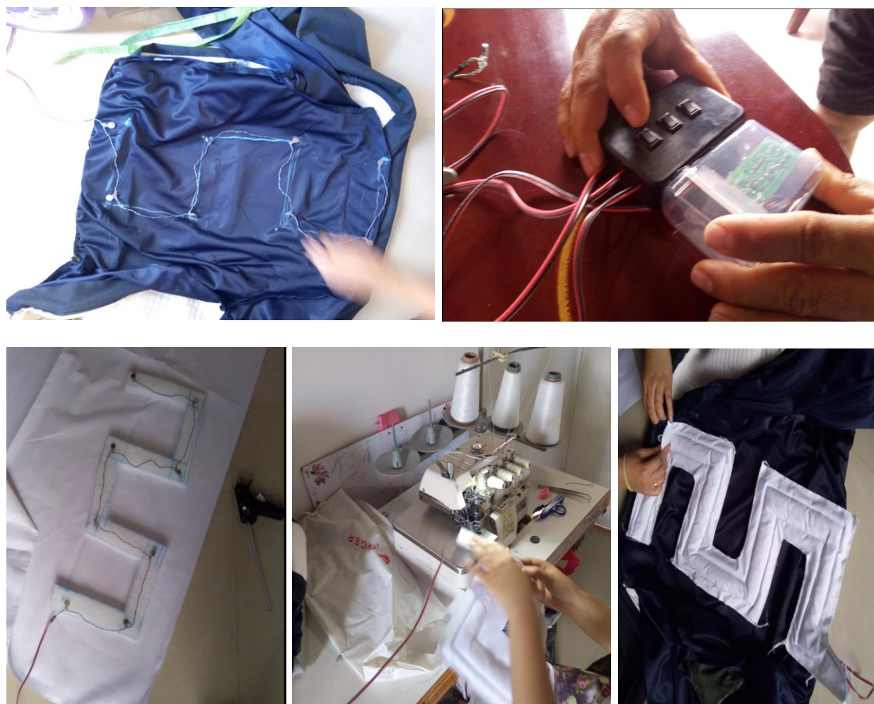
Figura 13. Instalación interna del sistema eléctrico.
