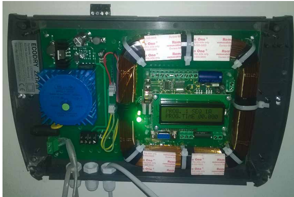
Bild 3.11. Avfuktare och konduktansmätning med borstgivare (uppe till vänster). Exempel på en konstruktion som ska torkas (uppe till höger). Processord avfuktare, masteranordning (EcoDry Zeta III) (nere till vänster). Slaveapparat (INPOINT) (nere till höger). (Foto: Esko Sistonen)
