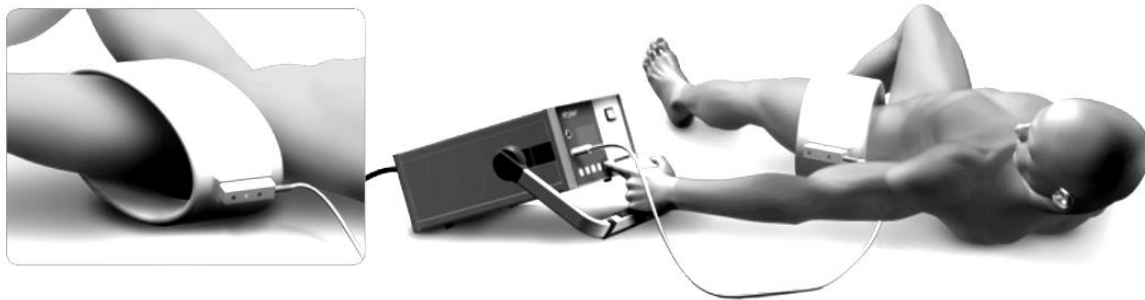
Abbildung 6: ASNIS-III-s-series Therapieeinheit: Schematische Darstellung zur Anwendung der s-series Therapieeinheit. Die Ringspule bzw. Primärspule ist um die Hüftregion platziert [138]
