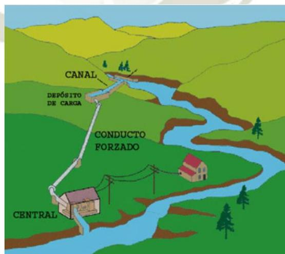
*Figura 5: Minicentral hidráulica de derivación*
