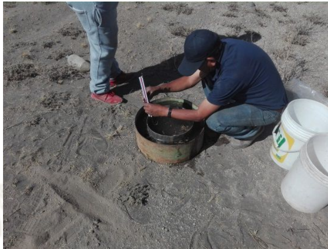
Figura 8 Instalación de cilindro para prueba de velocidad de infiltración in situ
