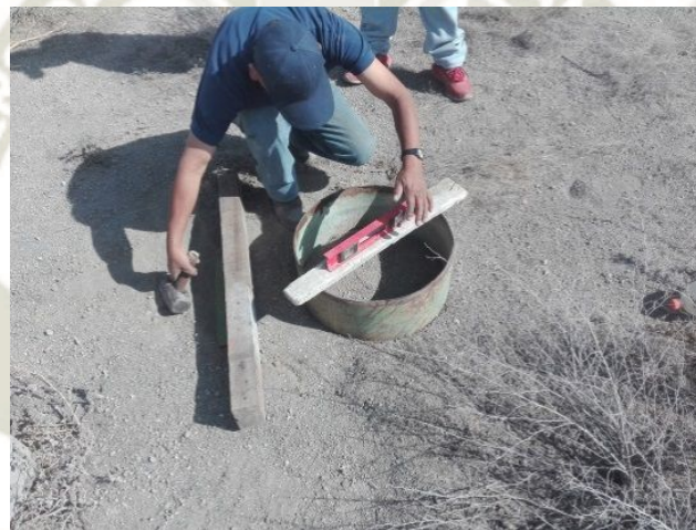
Figura 9 Punto de prueba de velocidad de infiltración in situ
